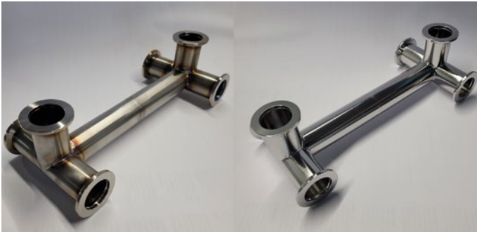
Abb. 2: Geschweißte Rohrbaugruppe links vor, rechts nach EPP/PEP
